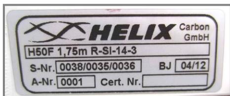
Zertifizierte Propeller sind im Typenschild mit entsprechender Cert. Nr. gekennzeichnet.
