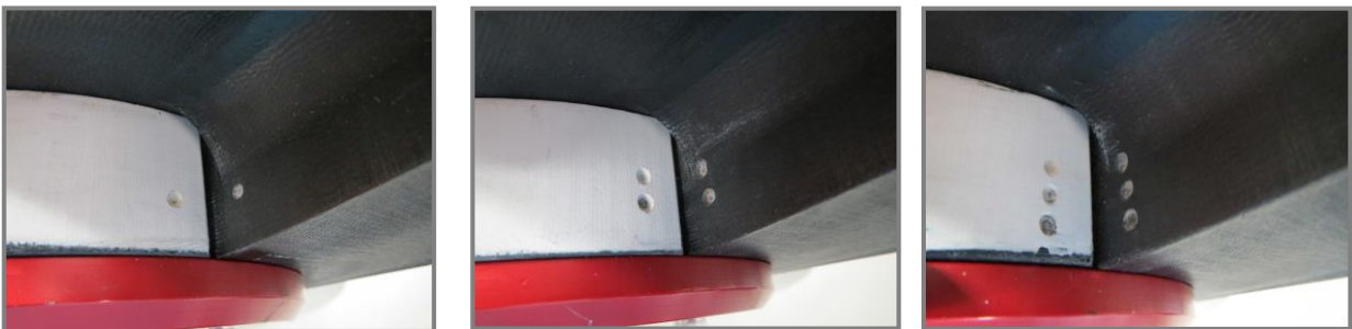
Bild 3: Anordnen der Blätter anhand der Fräsmarkierungen
