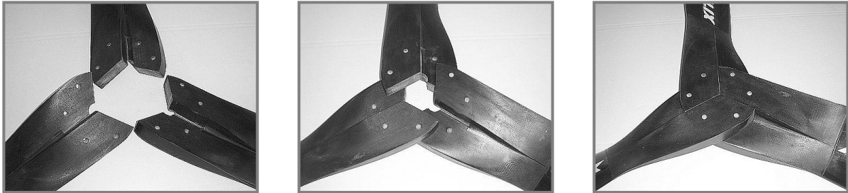
Bild 4: Zusammensetzen des 3-Blatt Propellers
