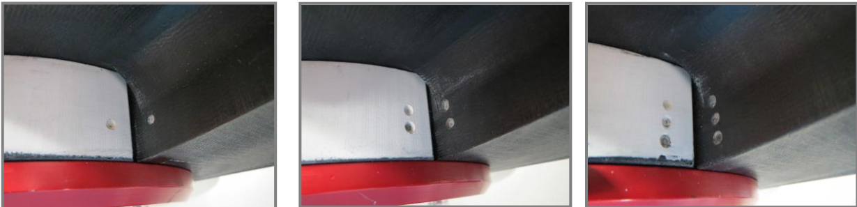
Bild 3: Anordnen der Blätter anhand der Fräsmarkierungen
